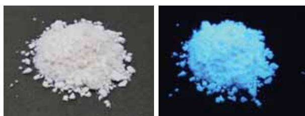
図 1 アルミナ蛍光体の UV ランプ ( \lambda_{\text{em}}=365 nm)照射前(左)と照射後(右)の様子
