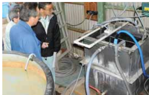
図2. 無電解めっき廃液処理用の磁化活性汚泥パイロットプラント (200 L)
