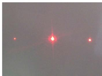
図2 偏光特性を有する回折格子からの回折パターン。右回り円偏光(右側)を強く回折する様子。
